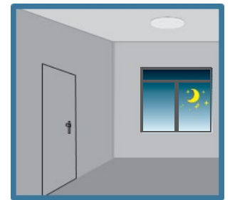
Efter standby-tiden släcks ljuset om ingen rörelse detekteras
