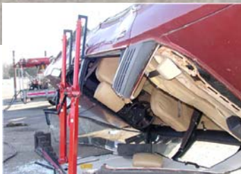
Bil liggande på taket kan lyftas för att ge utrymme för räddningsinsats
