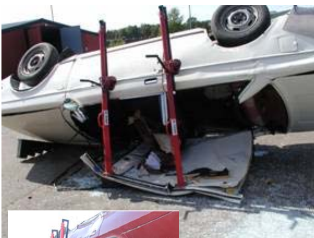
Bil liggande på taket kan lyftas för att ge utrymme för räddningsinsats
