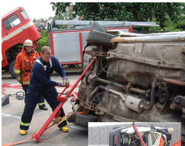
Liggande bil stabiliseras med stöttor. Säkringsband hindrar foten från att glida
