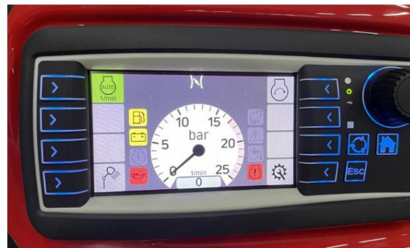
Belyst färgdisplay med vridreglage för varvtalsjustering och pumstrycksreglering
