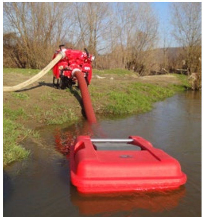
Dafos flytande sugsil filtrerar vattnet vid vattenytan och förhindrar därmed skador på pumpen.
