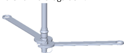
Figur 5.7: En 17 mm skiftnyckel används för 3/8" adaptar och en 20 mm skiftnyckel används för munstycken.
