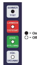
Figur 19 Inställning av servicelarm.
