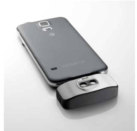
Figur 14.3 2015: FLIR One, ett tillbehör till iPhone- och Android-mobiltelefoner. Vikt: 90 g.
