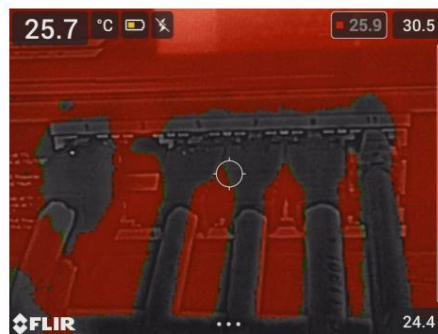
Över larm: Markerar alla pixlar med en temperatur över den angivna temperaturnivån.
