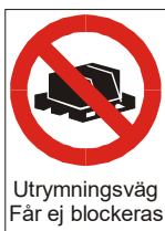
Utrymningsväg Får ej blockeras
